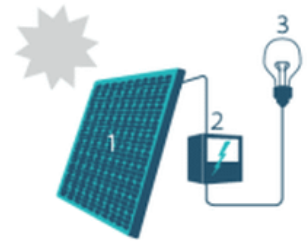
1. Zonnepaneel | 2. Omvormer | 3. Elektrische toestellen
